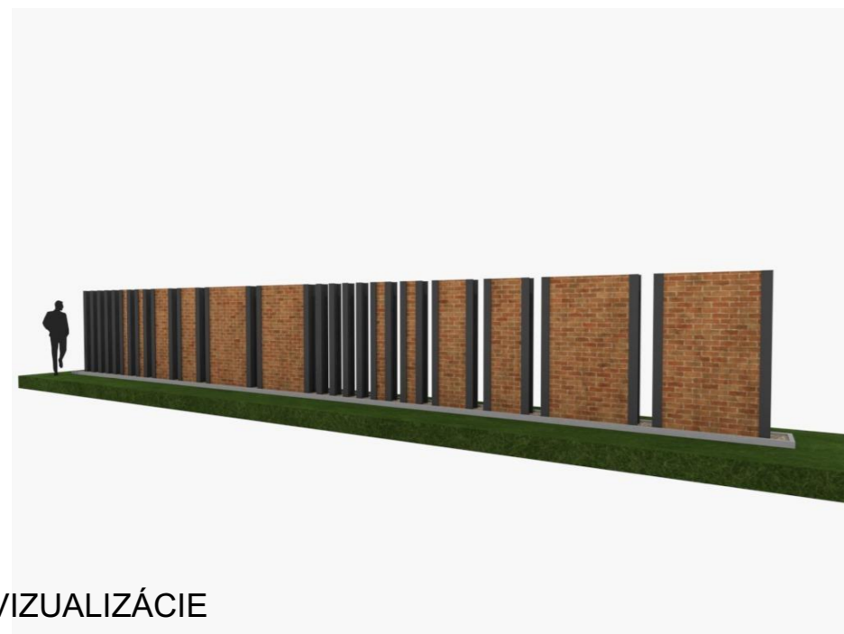
OPLOTENIE - POHLAD, m 1:50 - VÝŠKA OPLOTENIA 2,0m
